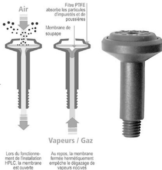
Lors du fonctionnement de l'installation HPLC, la membrane est ouverte
